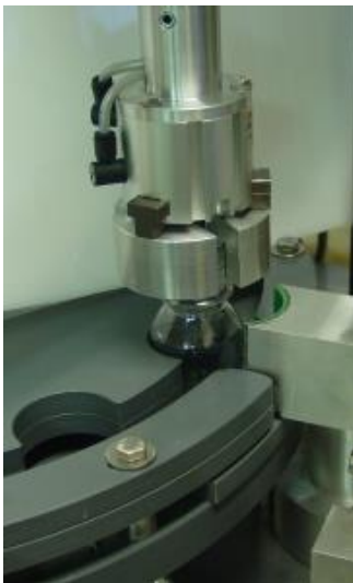
Greiferschrauber für sichere Drehmomentübertragung auch bei sehr glatten Verschlüssen
