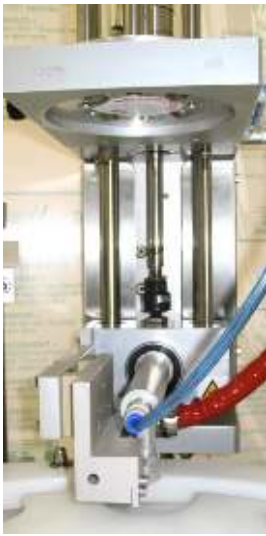
Auflege-Station für Folienscheiben mit Vakuumwender und Vorsiegeleinrichtung
