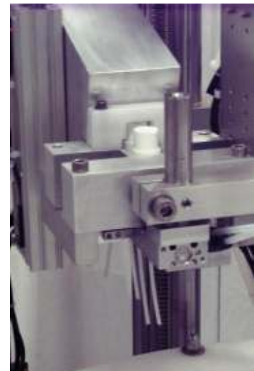
Einsetzer für Sprühpumpen inkl. Ausrichtung und Straffung des Steigrohres
